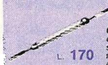
Contatto magnetico in bulbo di vetro Mod. H 15. Tipo: subminiatura. 1 contatto normalmente aperto. Materiale dei contatti: oro diffuso. Capacità fra i contatti: < 0,3 pF. Potenza max commutabile: 12 W. Corrente max commutabile: 0,6 A. Tensione max commutabile: 220 V.
