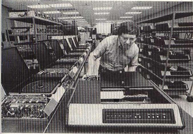
Fig. 16 - Un tecnico mentre completa il montaggio del videogrammofono Selecta-Vision nella fabbrica RCA di Indianapolis.
