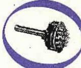
Commutatori rotativi. Per AF. Portata: 0,3 A - 125 V.c.a. Resistenza di contatto iniziale < 10 mΩ. Rigidità dielettrica: < 100 V.c.a. Contatti: bronzo fosforoso argentato. Settori: 1 in bachelite Ahgolo tra due posizioni: 30°. Numero max di posizioni: 12.
